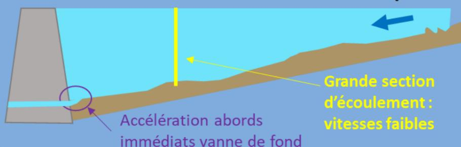
Le principe du protocole pilote est de maintenir la vanne de fond ouverte pendant un mois. Ainsi, la retenue est à côte basse à l'arrivée des épisodes de hautes eaux, les vitesses sont plus importantes sur l'ensemble du linéaire de la retenue, des sédiments supplémentaires vont pouvoir être emportés.
