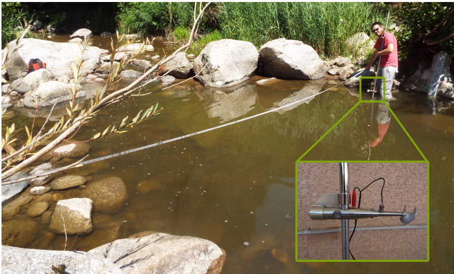
Section de jaugeage au micro-moulinet sur la rivière Dunière
